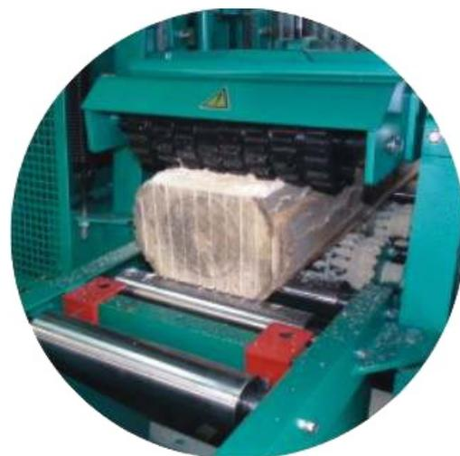
Вертикальный просвет: **350 мм / 240 мм.**
