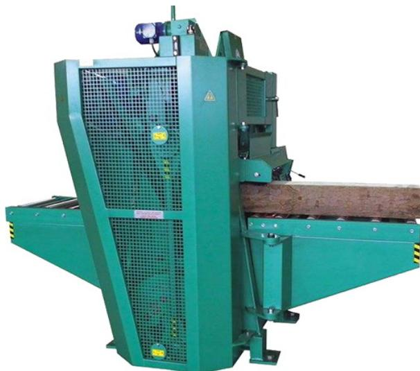
Модель WRP-58 предназначена для распила двухкантных брёвен на традиционные пиломатериалы: доски, брус, рейки. Модель WRP-38 была введена в производство со следующим назначением: распил очень тонких досочек и ламелей.
